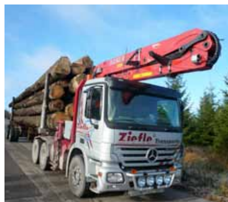
KESLA 2024 -puutavaranoosturi kokorunkopuun kaukokuljetukseen
