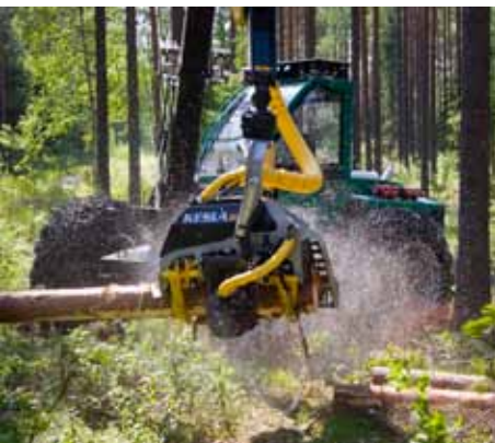
Pyörälustainen harvesteri varustettuna KESLA 20RH -harvesterikouralla ja KESLA 13105 -nosturilla
