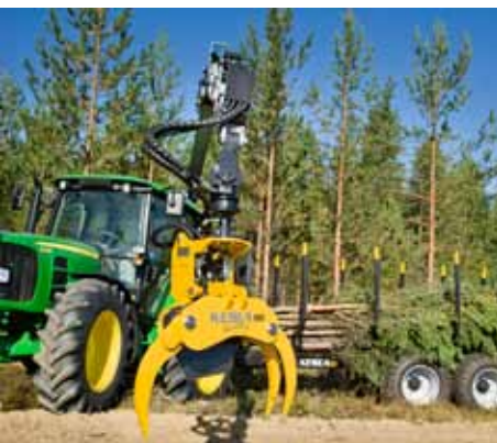
KESLA19GX -energiakoura, KESLA 304T -kuormain ja 12T -metsäperävaunu energiapuun keräämiseen ja lähikuljetukseen
