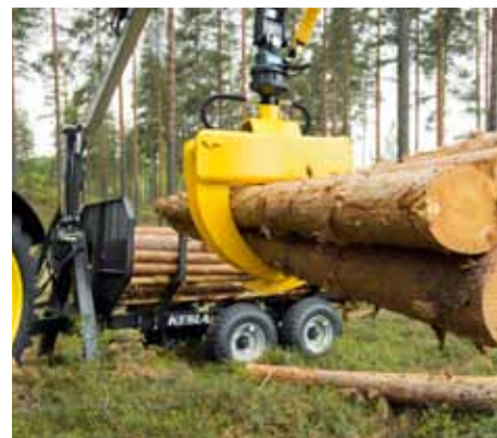
KESLA 152 -kuormain ja 71 -metsäperävaunu ainespuun lähikuljetukseen
