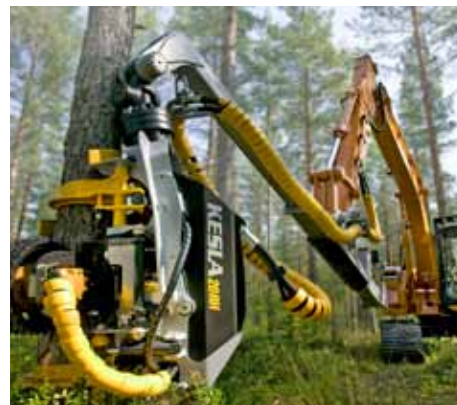
Kaivinkonepohjainen harvesteri varustettuna KESLA 20RH -harvesterikouralla ja KESLA XTimber -metsävarusteilla
