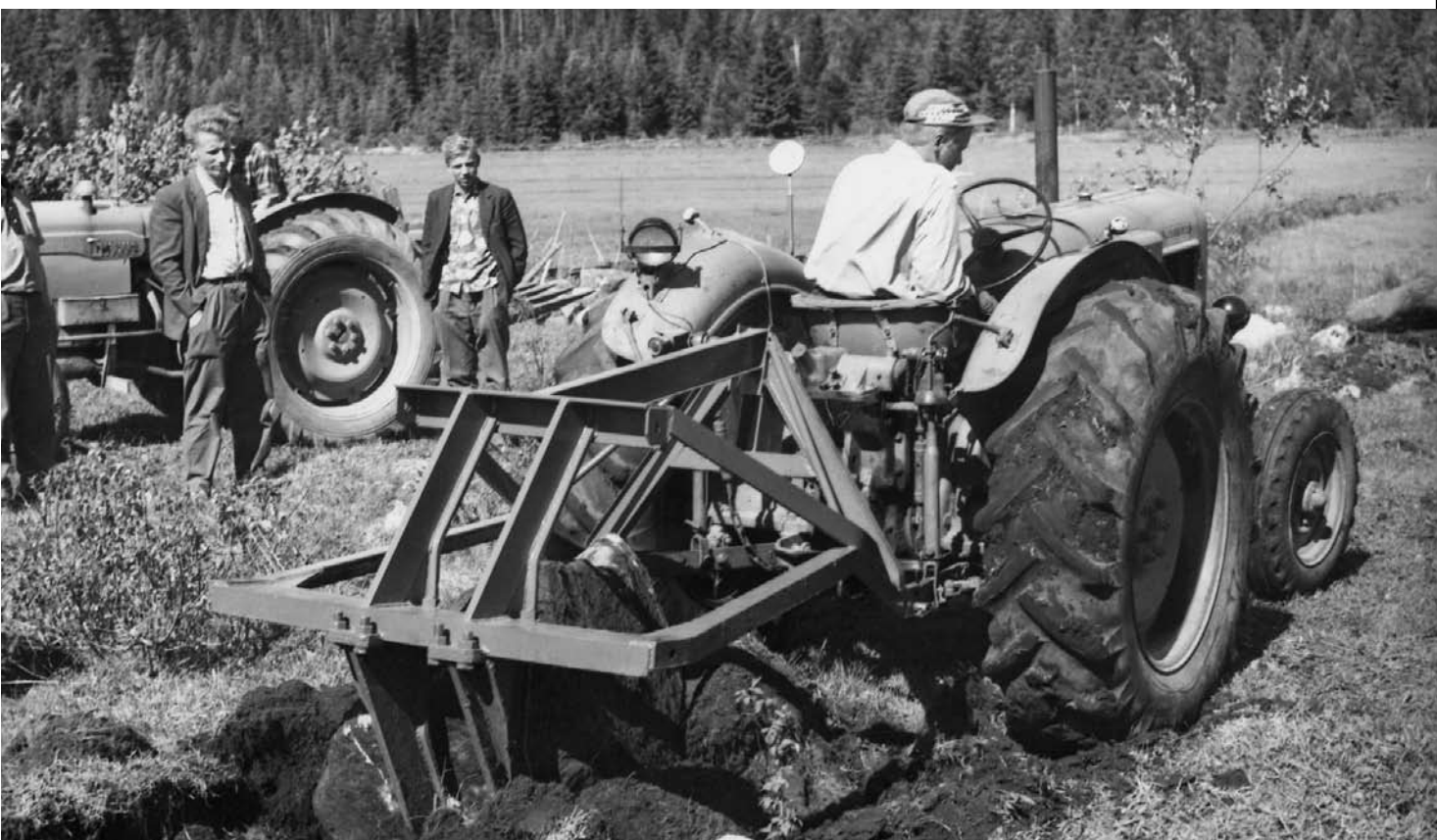
Keslan perustaja Antti Kärkkäinen testaamassa keksimäänsä raivauskoukku Iso-Kitaa Rantasalmella.
