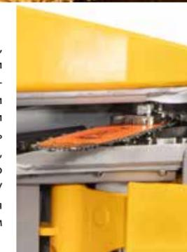
представляет собой пильный узел, размещенный на передней части головки, которая позволяет максимально использовать ветвистые и поврежденные деревья. Модели 20/25RH-II и 20/25SH-II есть возможность доукомплектовать вершинной пилой, которая устанавливается на место переднего фиксированного ножа. У моделей 29/30RH-II блок пилы является мощным фиксированным передним модулем головки.
