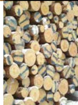
Цветомаркировка упрощает распределение сортиментов при транспортировке. Двухцветный маркер позволяет использовать 3 цветовых комбинации. Форсунки распыления краски находятся на заднем ноже, и оставляют четкие пометки.
