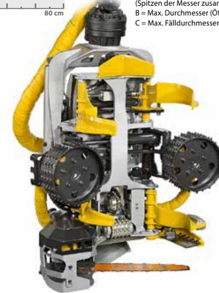
Das KESLA 20RH-II ist ein leistungsstarkes und wendiges Harvesteraggregat für Durchforst- und Schlagarbeiten leichter Bäume. Das leichte und stabil gebaute Harvesteraggregat hat eine für seine Größenklasse außerordentlich hohe Vorschub- und Schnittleistung. Vier Entastungsmesser machen das Rücken der Stämme einfach und die Entastungsergebnisse sind überragend. Das umfangreiche Zubehör umfasst u. a. proCon-, hydCon- sowie Farbmarkie-
