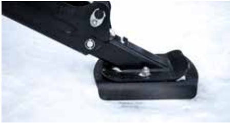
For KESLA 300 serien med A- og nedfellbare støtteben kan det leveres ekstra plater til bruk på bæresvak jord.
