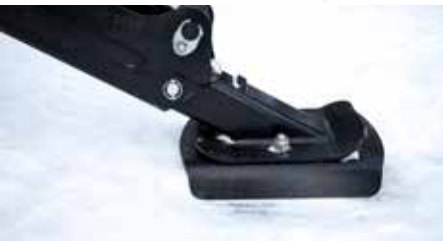
KESLA 300 sērijas A veida un nolaižamajām stabilizatora kājām ir pieejamas papildu plātnes.
