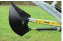
Eine Schaufel für Entwässerungsgräben aus dem Sortiment der Grabgeräte. (202T-203T)
