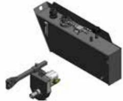
Ein LS-Pumpen-Set für Ladekrane der 300-Serie mit Stabilisatoren. Hydraulikfluss max. 150 l/min. (max. 280 bar). Hydrauliköltank 110 l.
