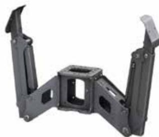
Für die A- und Flapdown-Abstützungen der KESLA 300-Serie sind zusätzliche Stützbeinplatten erhältlich.
