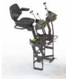
Ausführung Hochsitz mit elektrohydraulische Steuerung mit Walvoil-Joysticks und Walvoil Steuerventil DPX 100, nur für den japanischen Markt.
