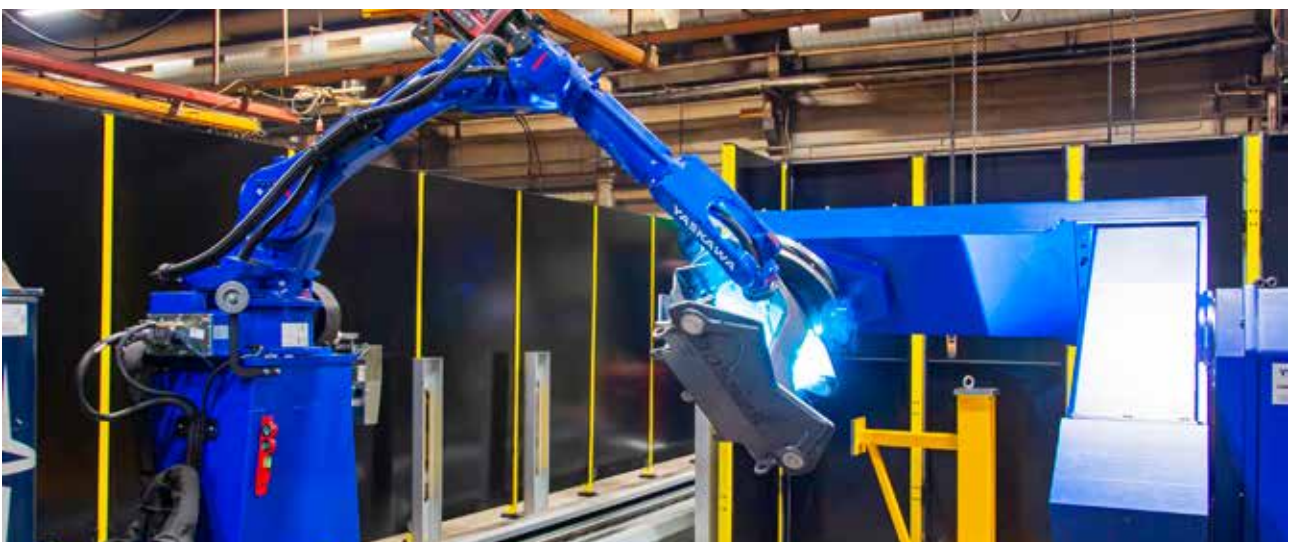
Robottihitsauksen sisäilmaan tuomat päästöt ovat helpommin hallittavissa, kuin käsinhitsauksen, sillä hitsaus on pisteittäistä.
